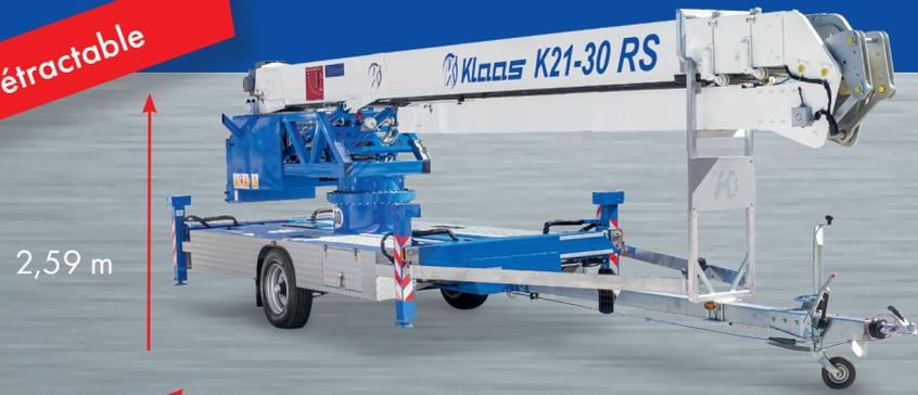
Hauteur sous crochet max. 29,8 m / Déport max. 21 m
