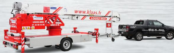
Tractable avec un véhicule léger 3,5t
