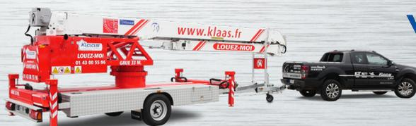
Tractable avec un véhicule léger 3,5t
