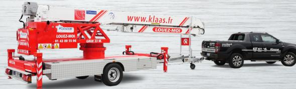
Tractable avec un véhicule léger 3,5t
